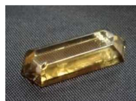
パイロット設備で育成した各種「GaN」結晶
