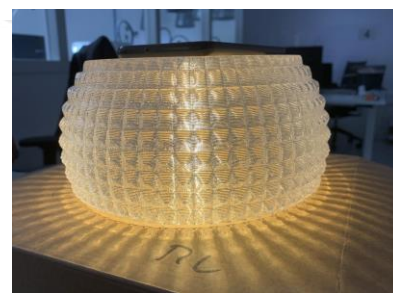
FDM 方式で弊社バイオ樹脂 デュラビオ TM を使用した照明カバー
