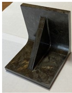
フェノールCFRP搬送ハンド、成型品（長繊維・短繊維／開発品）
