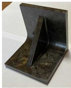
フェノールCFRP搬送ハンド、成型品 (長繊維・短繊維／開発品)
