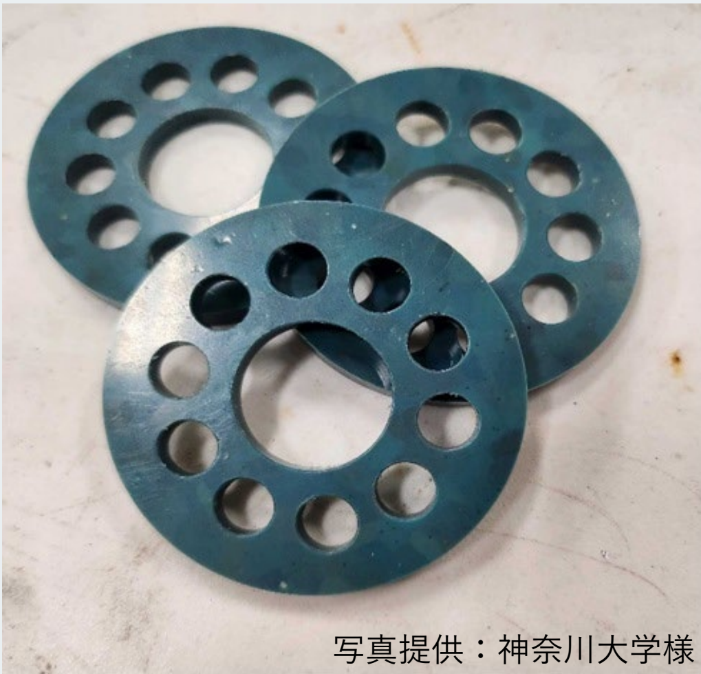
燃料用に成型した海洋プラスチック(PE) (提供：信州大学中山研究室)
