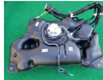
ポリエチレン製の自動車用燃料タンク
