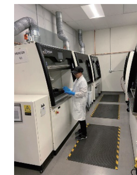
AddiFab製の3Dプリント鋳型の品質検査をする技術者(MCAMアリゾナ州イノベーション&テクノロジーセンター)
