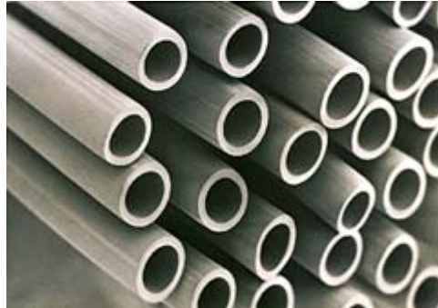
中空糸膜断面拡大写真
