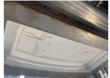
粉体プライマー噴霧後のプレス上型 Press upper die after spraying powder primer
