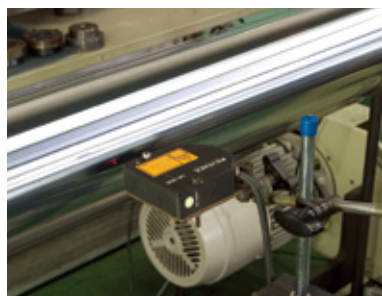
ロール回転時の動フレ測定
