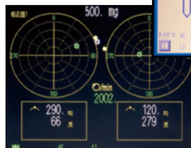
2000rpm回転時における動バランス
