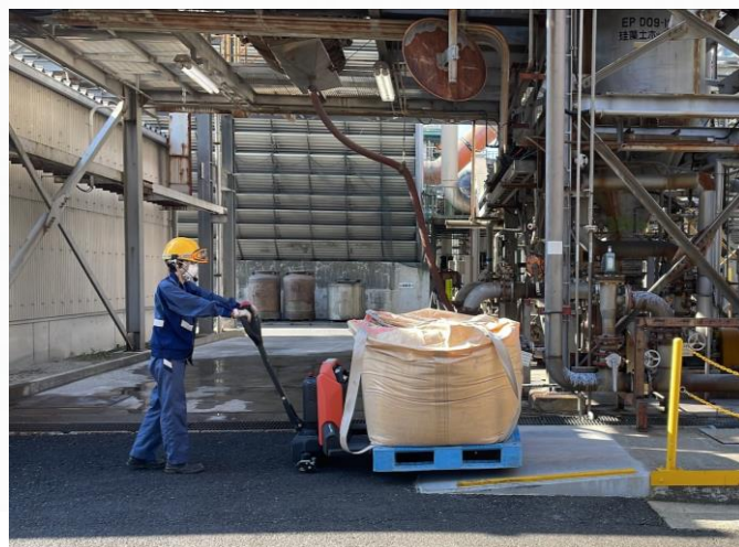
電動リフターで運搬作業をする様子
