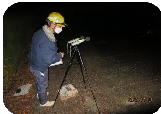
■騒音・振動測定の様子
