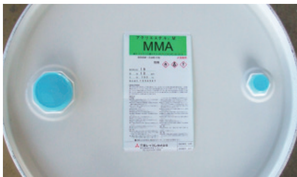
MMAモノマーのドラム缶天板に貼られたGHS対応ラベル
