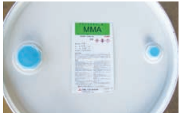
MMAモノマーのドラム缶天板に貼られたGHS対応ラベル
