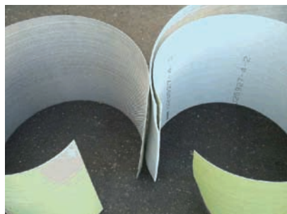
分離されたアルポリック廃材
