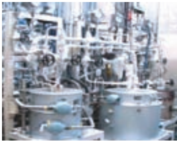
ガス爆発評価装置 (国内唯一の高圧ガス法特認設備)
