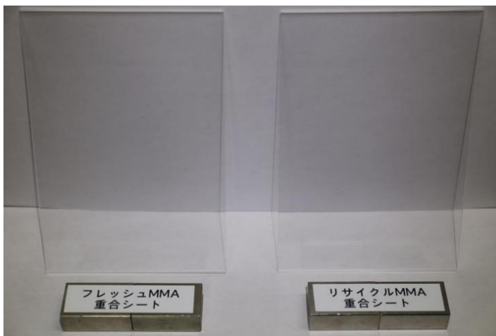
左が従来品、右がリサイクル品を使用したシート。透明性も遜色ありません。
