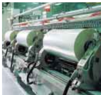
光学用ポリエステルフィルム製造設備
