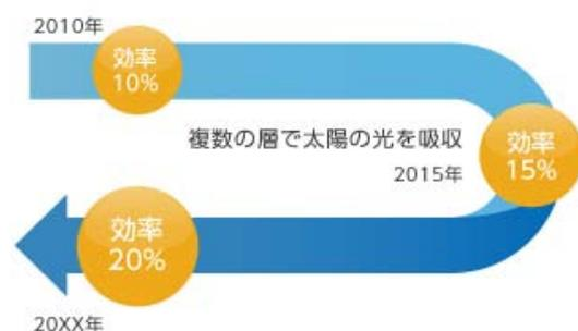
ナノレベルの材料開発、改良を重ねた結果、光電変換効率は、開発当初の約3%から、5%、7%と徐々に向上、2011年6月、ついに実用化の必須目標であった10%超に到達、世界最高を記録しました。2011年9月には、11%を達成しています。開発中のOPVは単層ですが、吸収できる波長の異なるOPVを複数層タンデムに重ねれば、より広い波長領域の高効率光電変換が可能のため、より高い変換効率を得ることができます。2015年までに15%をめざし、達成後は更なる技術革新で一層の高効率化を図る予定です。
