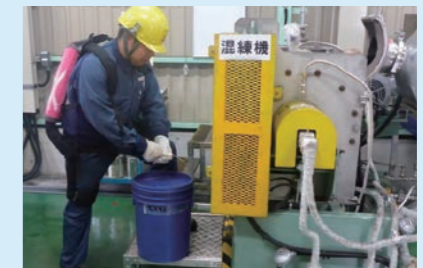
改善イメージ：パワースーツによる作業負荷軽減 (検証中)
